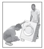
Zum Entfernen der Transportstabilisatoren neigen Sie die Maschine etwas nach hinten. Entfernen Sie die am Band befestigten Stabilisatoren.
