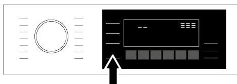
Когда пульт дистанционного управления включен, вы можете только включить машину, выключить ее и следить за состоянием через стиральную машину. А всеми функциями, кроме блокировки от детей, можно управлять через приложение.
