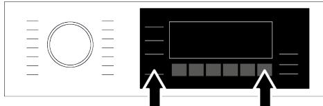
3. Вы услышите предупреждающий звуковой сигнал изделия, чтобы уведомить о вашем запросе после обратного отсчета на экране. Удаление согласования займет несколько секунд.
