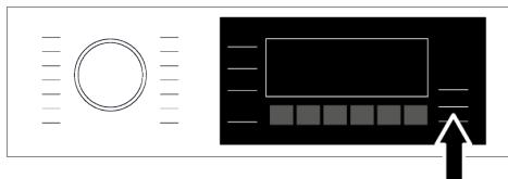
Если вы хотите отменить функцию «Время окончания», выключите и снова включите устройство, нажав кнопку включения/выключения.
