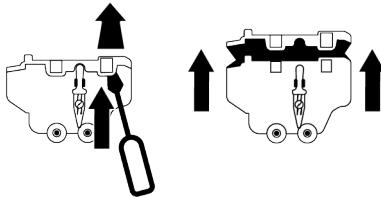
7. С помощью плоской отвертки снимаются направляющие, удерживающие верхнюю крышку отсека для моющих средств (всего их 6, по две справа, слева и сзади отсека) и моется внутренняя часть отсека.
