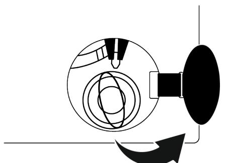
3. Потяните вниз аварийную ручку загрузочного люка с помощью инструмента и отпустите. Затем откройте загрузочную дверцу.
