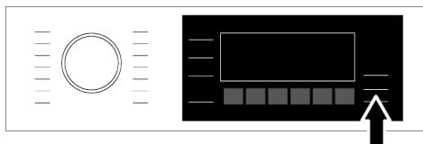
Если уровень воды в машине не подходит, когда вы нажимаете кнопку «Пуск/Пауза», блокировка дверцы не может быть деактивирована, а значок блокировки дверцы на дисплее остается включенным.
