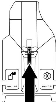
1. Нажмите на синую часть в середине отсека для моющих средств, чтобы потянуть его на себя и вынуть.
