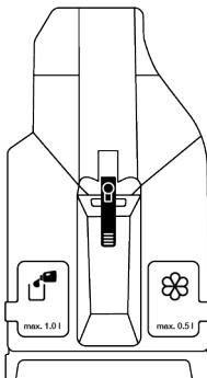
2. Чтобы добавить жидкое моющее средство (слева) и кондиционер (справа), откройте крышку соответствующего отсека, потянув ее вверх, как показано на рисунке.
