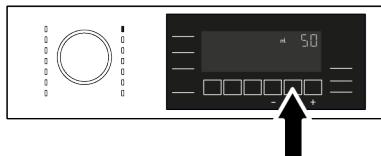
1. Нажмите кнопку Auto Dosage (Автоматическая дозировка). Когда функция использования жидкого моющего средства включена, а кондиционера для белья – выключена, становится активным экран настройки использования жидкого моющего средства. Когда функция использования жидкого моющего средства выключена, а кондиционера для белья – включена, становится активным экран настройки использования жидкого моющего средства. Загорается светодиодный индикатор экрана активных настроек.
