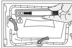
После очистки фильтра, дверцы и конденсатора перетащите щетку вправо и зафиксируйте ее на месте.
