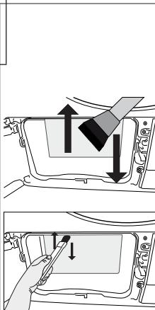
Прочистите волокно в направлении вверх-вниз на металлической поверхности конденсатора влажной тканью либо щеткой на воздушном дефлекторе. Не выполняйте очистку в направлении налево-направо, так как это может повредить металлические пластины конденсатора. Для уборки вы можете использовать пылесос со щеткой. Если пылесос не оснащен щеткой, то для очистки конденсатора его использовать не рекомендуется.
