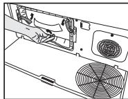
Сдвиньте защелки для открытия крышки воздушного дефлектора.
