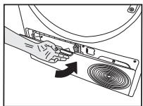
По окончании процесса очистки установите крышку воздушного дефлектора на место, сдвиньте защелки, чтобы закрыть ее, и закройте ограждительную планку.
