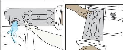
Если в воронке на резервуаре для воды скопилось волокно, удалите его под проточной водой.
