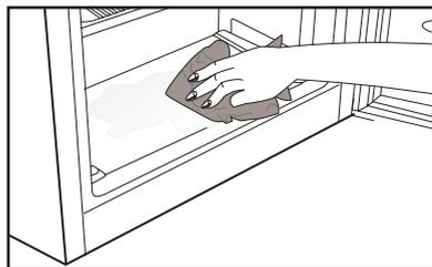
Nehmen Sie Zubehörteile (wie Ablagen, Schubladen, usw.) aus dem Gerät heraus und fangen Sie das Tauwasser mit einem geeigneten Behälter auf.
