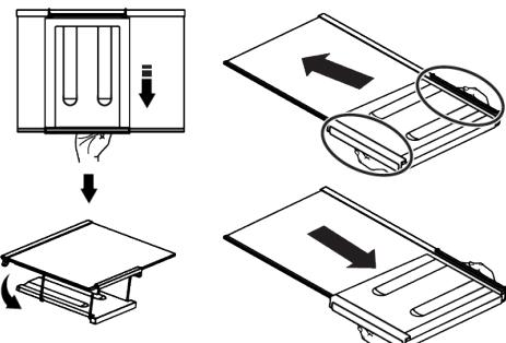
Za grupiranje preklopnog stala za vino, prvo uklonite staklenu policu iz hladnjaka. Stavite ga na staklenu policu tako da gurnete plastični dio kroz prednji i stražnji žlijeb kako je prikazano na slici. Proizvod će biti spremna za korištenje sa preklopnim stalom za vino.
