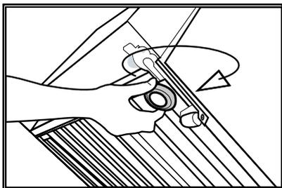
Для вертикальной регулировки дверей ,
