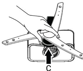
Чтобы разобрать и очистить сборку нижнего распылителя вместе, извлеките ее, ухватив точки (С), показанные на рисунке, одной рукой и поднимите вверх. После чистки установите сборку нижнего распылителя, следуя обратной процедуре.
