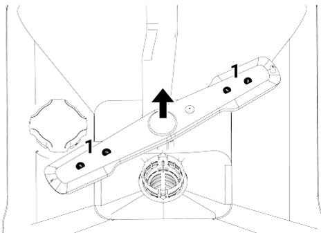
Проверьте, не забиты ли отверстия в сборке нижнего распылителя. Если они забиты, извлеките и очистите сборку нижнего распылителя. (в зависимости от модели)
