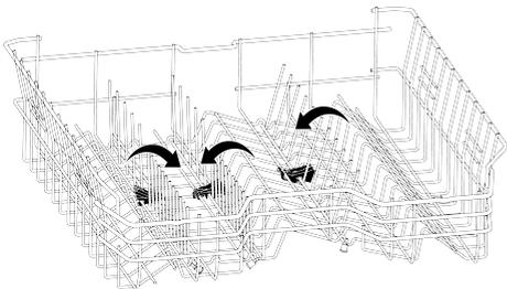
**i** Попытка перевести провода в горизонтальное положение, удерживая их за концы, может привести к их изгибу. Поэтому держите провода за нижнюю часть и нажимайте на них в направлении стрелки, чтобы перевести их в горизонтальное или вертикальное положение.
