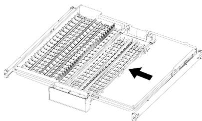
В моделях с частичной подвижностью, когда рычаг (1) на ручке нажимается, поддон в средней части корзины опускается в нижнее положение; система разблокируется, и правый и левый боковые поддоны можно свободно перемещать.
