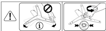
**i** Не пытайтесь вращать распылитель, удерживая его за концы. Попытка поворачивать распылитель за его концы может привести к поломке зубчатой передачи внутри распылителя.
