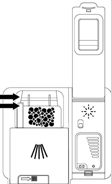
3. Закройте крышку отсека для моющего средства, нажимая в направлении стрелки. Вы услышите щелчок, когда крышка закроется.
