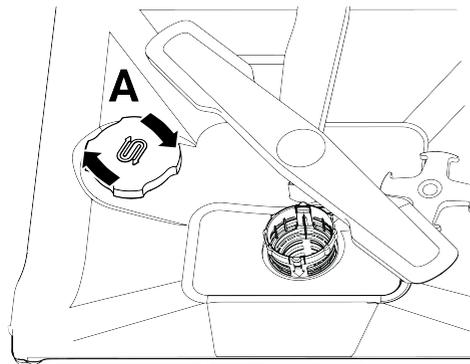
3. При первом использовании машины добавьте в отсек для соли всего 1 литр воды.
