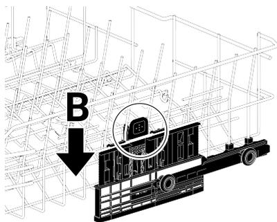
**i** Механизм подвижности может работать неправильно, если верхняя корзина перегружена или нагрузка распределена неравномерно. А в более тяжелых условиях она может перейти на следующую более низкую позицию.
