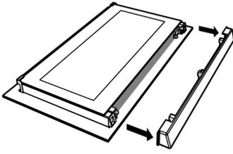
3. كما هو مبين في الشكل، ارفع الزجاج الداخلي (1) برفق باتجاه "A" ثم قم بإزالته عن طريق سحبه باتجاه "B".
