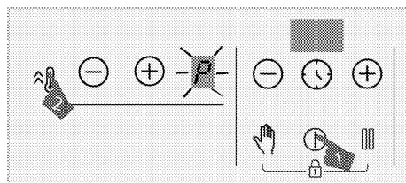
» Le foyer sélectionné fonctionne à la puissance maximale et le symbole « P » s'affiche sur son écran. La zone de cuisson quitte la fonction Booster et continue de fonctionner au niveau « 9 ».
