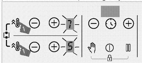
1. Pour allumer le foyer à grande surface pendant que l'un ou les deux foyers gauches fonctionnent, maintenez la touche  $\wedge\circ$  des deux foyers enfoncée pendant environ 3 secondes.
