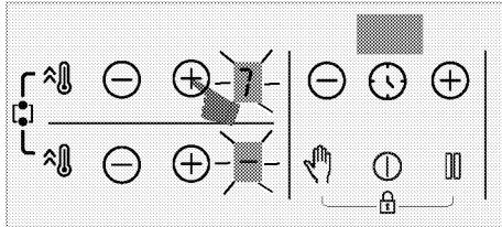
» Aby zmienić temperaturę, dotknij przycisków / lewej tylnej strefy gotowania i ustaw wybraną temperaturę.
