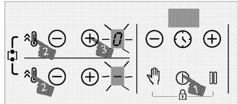
» „0” pojawi się na wyświetlaczu lewej tylnej strefy gotowania.  $\textcircled{0}$  pojawi się na wyświetlaczu lewej przedniej strefy gotowania, strefa gotowania o dużej powierzchni zostanie aktywowana.
