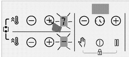
» Ak chcete zmeniť teplotu, dotknite sa tlačidiel  $\ominus/\oplus$  na ľavej zadnej varnej zóne a nastavte požadovanú teplotu.
