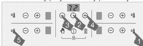
3. Ustawiony poziom zarządzania mocą zostanie wyświetlony na wyświetlaczu wyłącznika czasowego.
