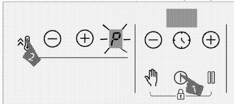
» Zvolená varná zóna bude v prevádzke pri maximálnom výkone a na displeji varnej zóny sa objaví symbol "P". Varná zóna vypne posilňovač a bude pokračovať v činnosti na úrovni "9".
