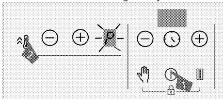
» Izabrana zona za kuvanje će raditi maksimalnom snagom i simbol „p“ će se pojaviti na displeju zone za kuvanje. Funkcija pojačavača zone za kuvanje se isključuje i nastavlja da radi na nivou „9“.
