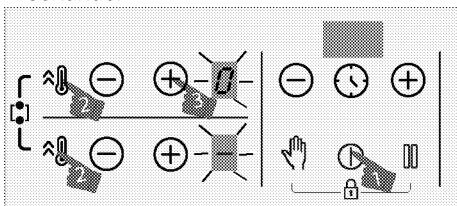
» „0“ će se pojaviti na displeju zadnje leve zone za kuvanje. „p“ će se pojaviti na displeju prednje leve zone za kuvanje i šira površina ploče za kuvanje će se pokrenuti.
