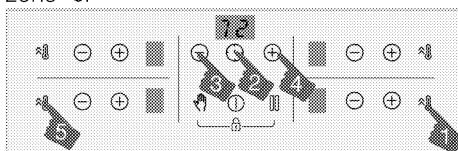
**i** Nivoi temperature koje možete dodeliti pločama za kuvanje mogu se razlikovati u skladu sa ukupnim podešenim nivoom napajanja. Nivo temperature na ploči za kuhanje automatski će se smanjiti u skladu sa podešavanjem napajanja koje štednjak vrši. Ovo nije greška.
