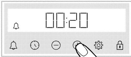
» Nach der Einstellung der Alarmzeit bleibt das symbol 🔔 weiterhin beleuchtet und die Alarmzeit startet den Countdown der Anzeige. Wenn die Weckzeit und die Garzeit gleichzeitig eingestellt sind, wird die kürzere Zeit auf dem Display angezeigt.
