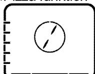
Undervarme og ventilator-understøttet opvarmning kører. Egnet til bagning af pizza.
