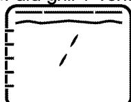
Varm luft, der opvarmes af den fulde grill, spredes meget hurtigt i ovnen ved hjælp af ventilatoren. Dette er velegnet til at grille en stor mængde kød.
