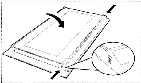
2. Povucite plastični dio pričvršćen na gornjem dijelu ulaznih vrata prema sebi istovremeno pritiskom na tačke pritiska sa obje strane dijela i izvadite ga.
