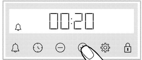
» Nach der Einstellung der Alarmzeit bleibt das symbol
