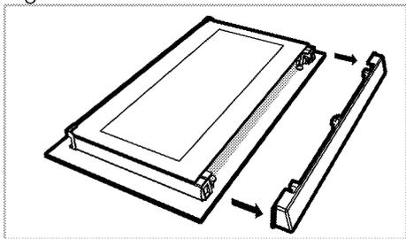
3. Kao što je prikazano na slici, malo podignite staklenu ploču s unutarnje strane (1) prema „A“ a zatim je izvadite povlačenjem prema „B“.
