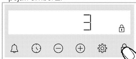
» Pojavi se simbol 🗄️ i na zaslonu počinje odbrojavanje 3-2-1. Kada se odbrojavanje završi, aktivira se zaključavanje tastera. Kada se dodirne bilo koja tipka dok je postavka zaključavanje tipki, tajmer daje zvučni signal i simbol 🗄️ treperi.
