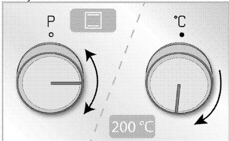
1. Izaberite radnu funkciju na kojoj želite da spremate hranu pomoću okruglog dugmeta za izbor funkcija.
