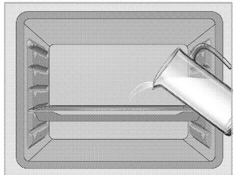
3. Stellen Sie den Backofen auf einfache Dampfreinigung ein, lassen Sie ihn bei 100 °C 15 Minuten laufen.
