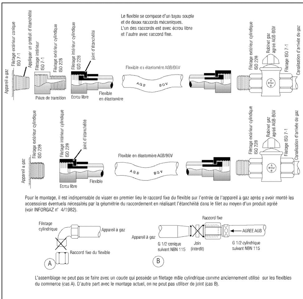
Montage En fonction du type de filet pour le raccordement de l'appareil (ISO 7-1 ou NBN EN ISO 228-1) le flexible
