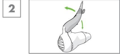
If necessary change the mains voltage setting (115 = 115 - 120 V-, 230 = 230 - 240 V-). Gerekirse şebeke gerilimini değiştirin (115 = 115 - 120 V-, 230 = 230 - 240 V-).
