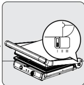
Установите ползунок регулировки уровня (2) на желаемый уровень ( I - II - III ) и закройте верхнюю ручку (9), потянув вниз.
