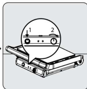
Для запуска устройства поверните переключатель включения/выключения (8) в положение "I". Установите ручку термостата (6) в положение, в котором вы хотите готовить.
