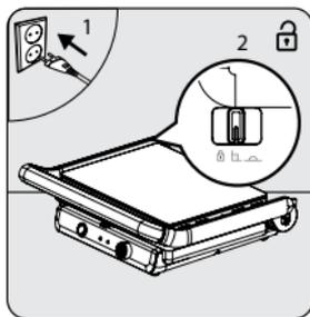
Установите фиксирующий ползунок (1) в полуоткрытое положение "I".
