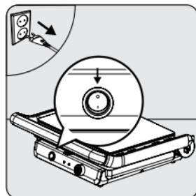
Для выключения устройства поверните переключатель включения/выключения (8) в положение "I" и отсоедините от питания.
