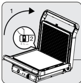
Слегка приподнимите верхнюю крышку устройства и переместите фиксирующий ползунок (1) в полуоткрытое положение "II". Откройте верхнюю крышку устройства вверх, держась за ручку (9).
