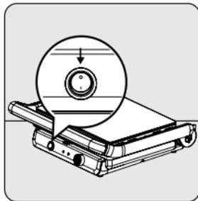
Для выключения устройства поверните переключатель включения/выключения (8) в положение "0".
