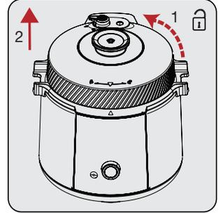
اترك الجهاز يبرد بعد الطهي للسماح للبخار بالتسرب بشكل طبيعي. قد يستغرق هذا ما يقرب من 10-15 دقيقة. بعد التبريد، حرر البخار بتحويل صمام البخار إلى وضع الفتح.
