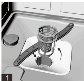
Pasul 1: rotiți în sens invers filtrul grosier, apoi ridicați-l;
