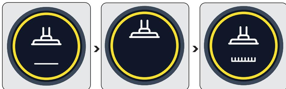
При перемещении щетки автоматического определения пола (8) с твердого пола на ковровое покрытие, цифры, показанные выше, должны будут показаны на дисплее (4).
