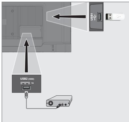
1 Подключите внешний жесткий диск к USB-интерфейсу **USB2 (HDD)** телевизора;
