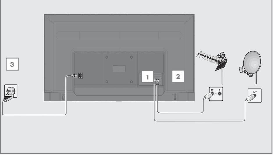
**1** Dijital uydu kanalları (DVB-S) için uydu anteni kablosunu televizyon seti üzerindeki »**SATELLITE**« anten girişine takın;
