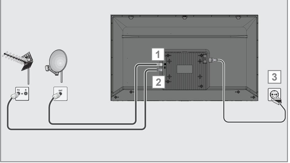
**1** Dijital uydu kanalları (DVB-S) için uydu anteni kablosunu televizyon seti üzerindeki **SATELLITE** anten girişine takın;
