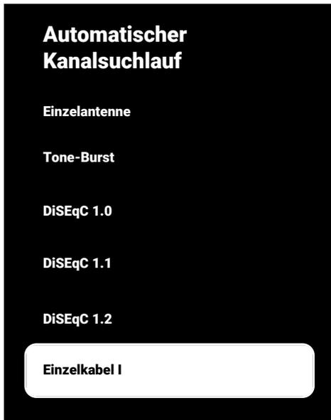
⇒ **Einzelkabel I:** Bei Verwendung eines Einzelkanal-Routers können maximal 8 verschiedene Geräte mit demselben Kabel übertragen werden.
