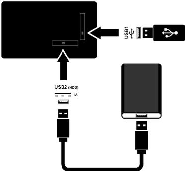
1. Schließen Sie die externe Festplatte an die USB-Schnittstelle **USB2 (HDD)** oder schließen Sie den USB-Speicherstick an die Schnittstelle **USB1** an.
