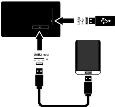
1. Schließen Sie die externe Festplatte an den Anschluss **USB2 (HDD)** oder schließen Sie den Speicherstick an den Anschluss **USB1** des TV-Sets.
