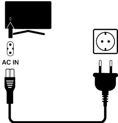
1. Verbinden Sie das Netzkabel mit der Stromsteckdose.
