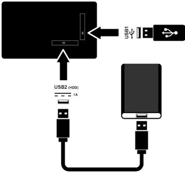
1. Schließen Sie die externe Festplatte an die USB-Schnittstelle **USB2 (HDD)** oder schließen Sie den USB-Speicherstick an die Schnittstelle **USB1** an.
