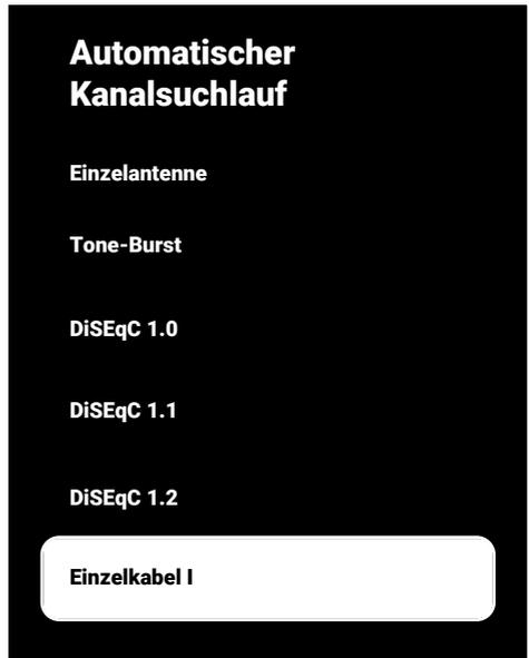
⇒ **Einzelkabel I:** Bei Verwendung eines Einzelkanal-Routers können maximal 8 verschiedene Geräte mit demselben Kabel übertragen werden.
