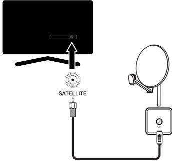
1. Für den Empfang von digitalen Satellitensendern (DVB-S) stecken Sie das Satellitnantennenkabel die Antennenbuchse **SATELLITE** am Fernsehgerät;
