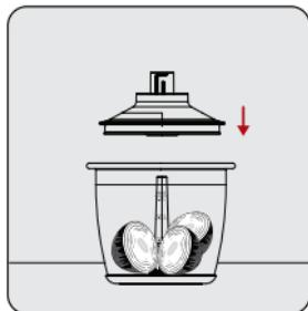
Setzen Sie den Deckel (6) auf den Arbeitsbehälter für den Zerkleinerer (8). Stellen Sie sicher, dass der Deckel (6) sicher in der Schüssel eingerastet ist.
