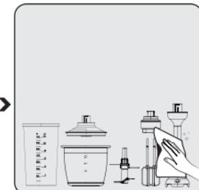
Prije čišćenja isključite uređaj. Pripazite jesu li se svi dijelovi uređaja potpuno zaustavili. Jedinicu motora (4) obrišite vlažnom krpom.
