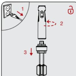
После завершения работы извлеките штепсельную вилку из розетки. Отсоедините блок двигателя от держателя венчиков (7), повернув его по часовой стрелке " $\Theta$ ".
