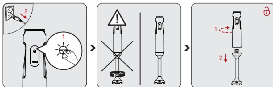
Kada se postupak završi, pustite gumb uključivanja/isključivanja (2). Iskopčajte uređaj iz strujne mreže.
