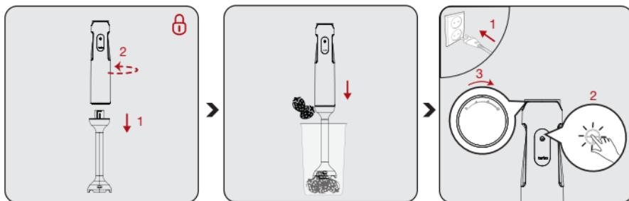
Pričvrstite štapni mikser (12) na jedinicu motora (4) okretanjem kraja jedinice motora (4) "Ⓐ" u smjeru suprotnom od smjera kazaljke sata.
