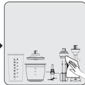
Ziehen Sie vor dem Reinigen den Netzstecker. Stellen Sie sicher, dass alle Geräteteile vollständig zum Stillstand gekommen sind. Wischen Sie die Motoreinheit (4) des Gerätes mit einem feuchten Tuch ab.
