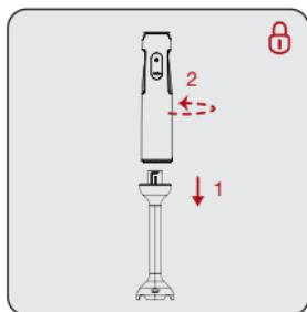
Установите вал блендера (12) на блок электродвигателя (4), повернув конец блока (4) “∅” против часовой стрелки.
