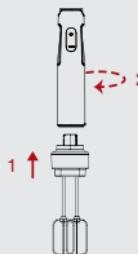
Установите держатель венчиков (7) на электродвигатель (4), повернув по часовой стрелке " $\Theta$ ".
