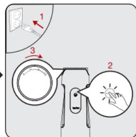
Подключите устройство к розетке. Нажмите кнопку питания (2) и работайте с прибором. Затем отрегулируйте скорость, поворачивая регулятор скорости (1).
