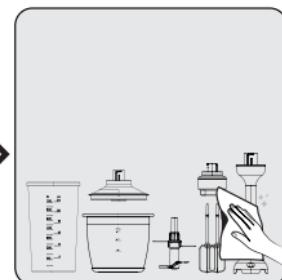
Înainte de curățare scoateți aparatul din priză. Asigurați-vă că toate componentele mobile ale aparatului s-au oprit în totalitate. Ștergeți cu o cârpă umedă unitatea motorizată (4) a aparatului.
