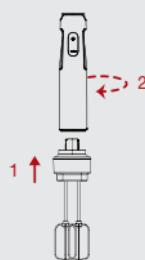
Stecken Sie den Schneebesenhalter (7) in die Motoreinheit (4), indem Sie ihn gegen den Uhrzeigersinn „“ drehen.
