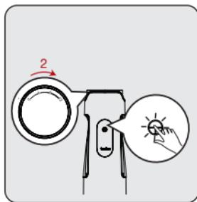
Drücken Sie die Power-Taste (2) und nehmen Sie es in Betrieb. Stellen Sie dann die Geschwindigkeit durch Drehen des Geschwindigkeitsreglers (1) ein.
