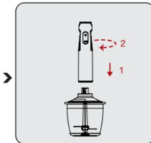
Setzen Sie die Motoreinheit (4) auf den Deckel (6).
