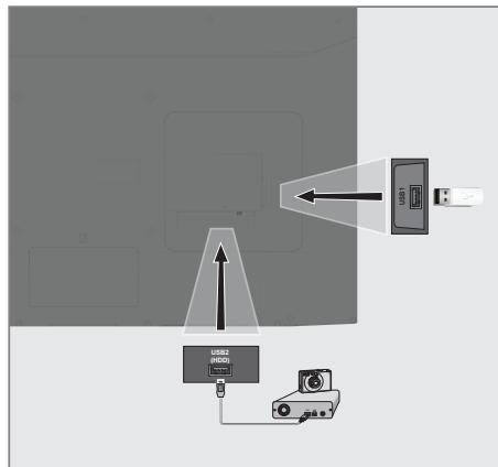
1 Schließen Sie externe Datenträger (z. B. externe Festplatte, Digitalkamera, Kartenleser oder MP3-Player) über ein USB-Kabel an den **USB2 (HDD)**-Anschluss Ihres Fernsehgerätes an.
