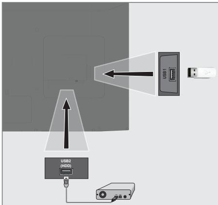
1 Verbinden Sie eine externe Festplatte mit dem **USB2 (HDD)**-Anschluss des Fernsehgerätes.
