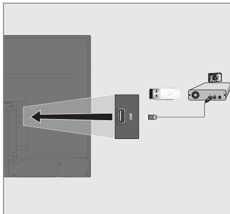
1 Televizyonun üzerindeki »**USB**« USB arayüzü ile harici cihazın üzerindeki ilgili veri çıkışını (harici sabit disk, dijital kamera, kart okuyucu veya MP3 oynatıcı) bir USB kablosu ile bağlayın.
